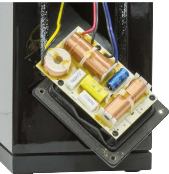
*Alle spalle della vaschetta portacontatti è fissata la scheda del filtro crossover. Notare le due induttanze dei woofer avvolte su nucleo di lamierini e quella del tweeter avvolta in aria.*
