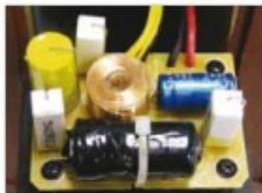
Tesi 260:n jakosuodin on basson osalta ensimmäistä astetta (6 dB/oktaavi). Elektrolyyttikondensaattori ja vastus tasaavat elementin impedanssia.
