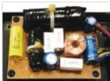
Tesi 542:n jakosuotimessa on kolmitieperitteen lisäksi kolme muuta osaa.
