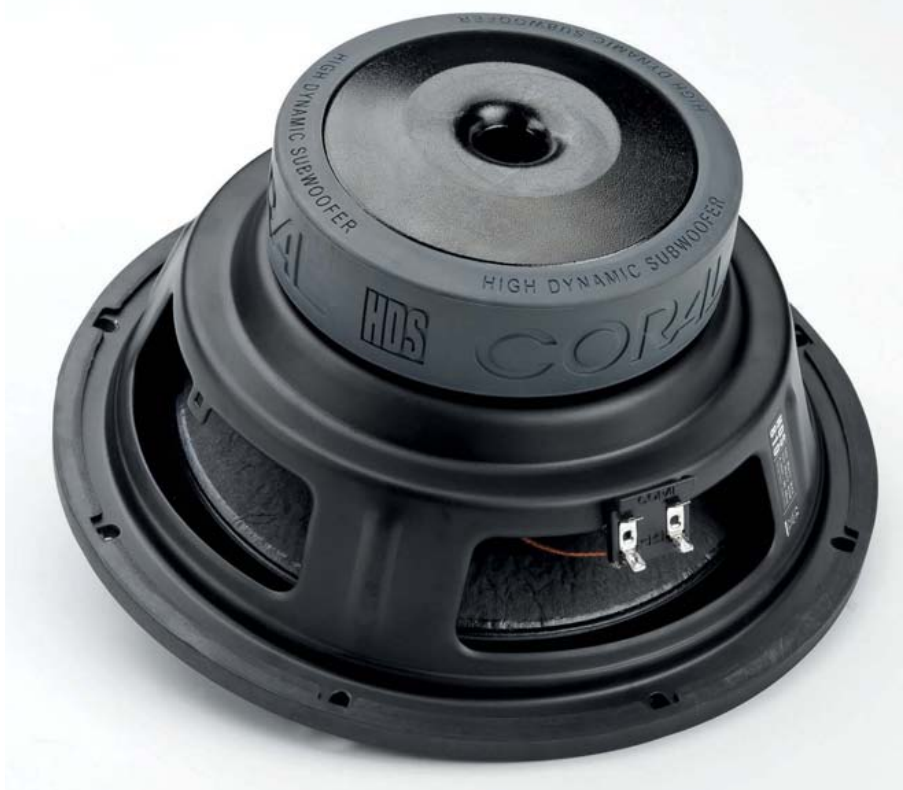
Il massivo complesso magnetico è coperto da una protezione in gomma, che può anche fungere da utile "accoppiatore smorzante" con eventuali sistemi di vincolo meccanico inseribili all'interno del box di carico. Come negli altri HDS il cestello è in acciaio stampato.
